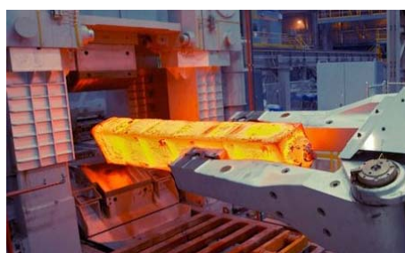
Рис. 1. Процесс протяжки плоскими бойками на предприятии Faircrest Steel Plant США (а) и Uddeholm's HAGFORS (б)
