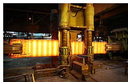
Рис. 1. Процесс протяжки плоскими бойками на предприятии Faircrest Steel Plant США (а) и Uddeholm's HAGFORS (б)
